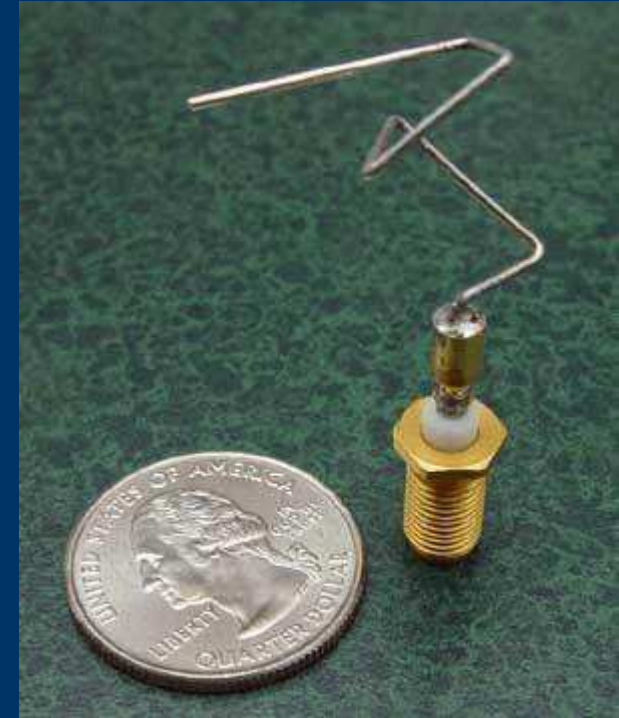
anténa NASA družice Space Technology 5 (ST5) na měření magnetosféry (2006)
